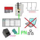
Über digitalen Eingang getriggerte DB-Sicherung/-Wiederherstellung ohne zusätzlichen PC über MPI/Profibus auf SD-Karte
