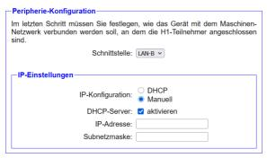
Festlegen der Schnittstelle an der das Maschinen-Netzwerk angeschlossen ist
