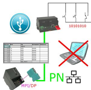
Über digitalen Eingang getriggerte DB-Sicherung/-Wiederherstellung ohne zusätzlichen PC über MPI/Profibus auf USB-Stick
