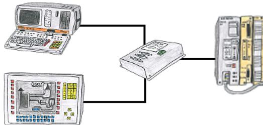
Ihre PG-Schnittstelle der S5-SPS ist bereits mit einem Panel belegt und Sie sollten Programmänderungen in der Steuerung durchführen ohne das Panel abzuziehen? Kein Problem, Sie schließen einmalig den Mini-MUX an der SPS an und dann am Multiplexer das Panel sowie Ihren PC. Schon können Sie parallel an der Steuerung arbeiten ohne dass die Bedienung über das Panel leiden muss.
