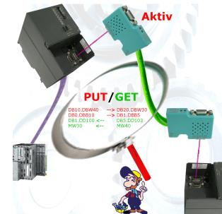
Direkter Datenaustausch zwischen S7-SPS-Steuerungen mit S7-LAN.
