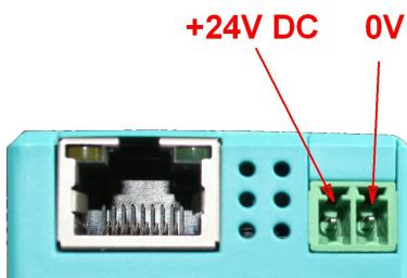
**Vor Einsatz der externen Speisung die Belegung des Phoenix-Steckers prüfen! Das Modul selbst ist gegen eine Verpolung geschützt, aber bei Aufstecken auf eine weitere Baugruppe kann dafür nicht garantiert werden.**
