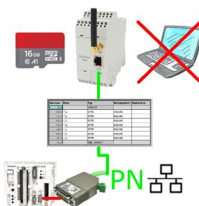
S5-SPS getriggerte DB-Sicherung/-Wiederherstellung ohne zusätzlichen PC über PG-Buchse und Ethernet auf SD-Karte
