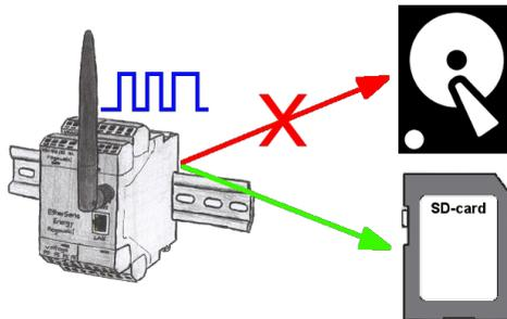
Durch den integrierten SD-Karten-Slot sichern Sie die aufgezeichneten Daten im Gerät und benötigen keinen externen Speicherplatz. Nichts desto trotz können Sie die Daten zusätzlich per FTP an einen FTP-Server senden.
