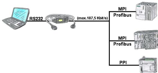
Mit dem MPI/PPI-Kabel sind Sie in der Lage mit Ihrem PC seriell mit bis zu 115200 Baud auf eine angeschlossene SPS-Steuerung S7-200 (PPI 9600 Baud und 19200 Baud) sowie S7-300/400 (MPI/Profibus 9600 Baud bis 187500 Baud) zu zugreifen um Daten aus der Steuerung zu lesen bzw. schreiben.
