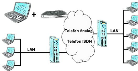
Das Tele-Prof-II kann auch als Router für den Zugriff vom PC aus mittels einer DFÜ-Verbindung eingesetzt werden, so dass eine Kommunikation mit dem sich dahinter verborgenen Netzwerk ergibt. Des Weiteren kann mit der TP-II TP-II-Strecke eine Netzwerkverbindung hergestellt werden, wobei sich aber der IP-Adress-Stamm unterscheiden muss.
