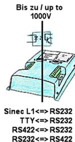
Koppeln von 2 Geräten mit unterschiedlichen Hardware-Schnittstellen?
